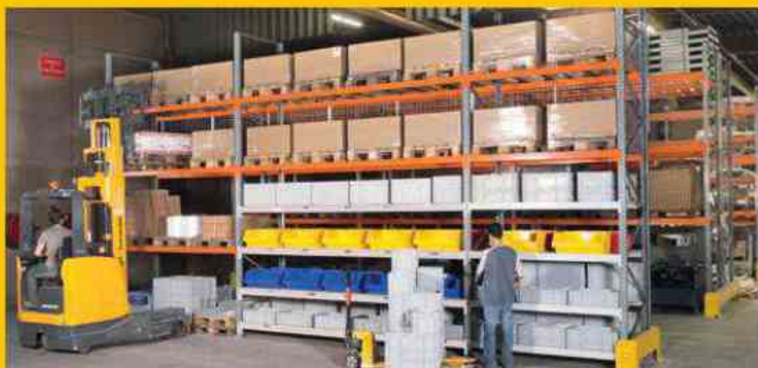
Rayonnage Epsirack « hybride » dédié au stockage de charges lourdes palettisées et le picking.
